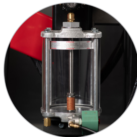
Lubricación Automática de Herramientas
