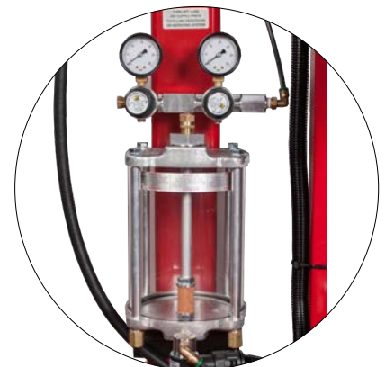
Tanque de lubricación automática
