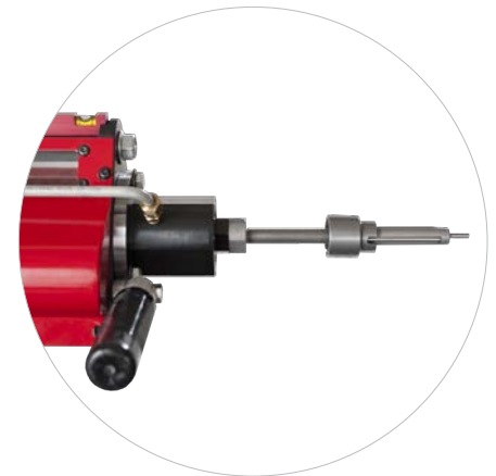
Lubricación Automática De La Herramienta A Través De La Jaula
