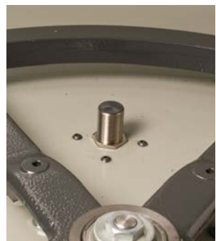
Sensor de Apagado de Seguridad
